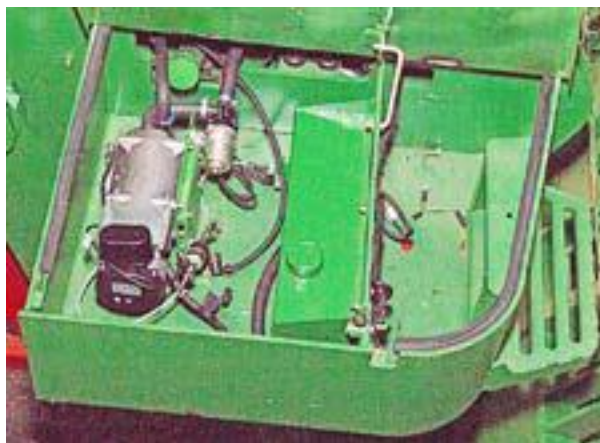
Рисунок 2.10 — Месторасположение бака и жидкостного подогревателя Прамотроник 16ЖД24
