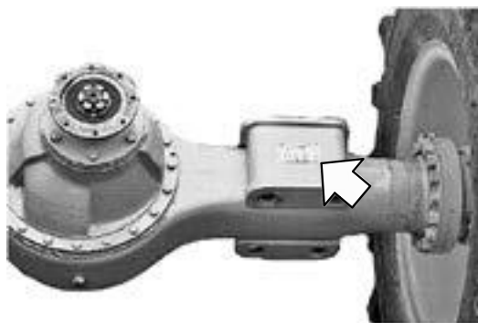
Рисунок 1.13 — Расположение маркировочной таблички подмоторного моста
