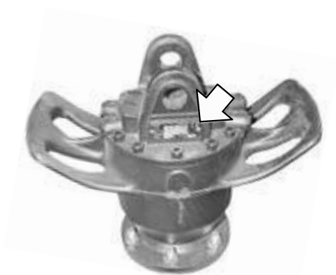
Рисунок 1.15 — Расположение маркировочной таблички ротатора
