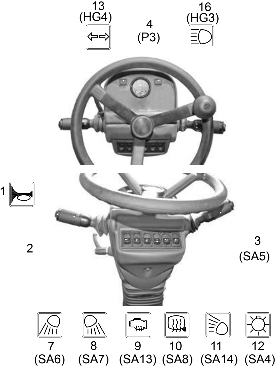
Рисунок 2.8 — Электрооборудование рулевой колонки
