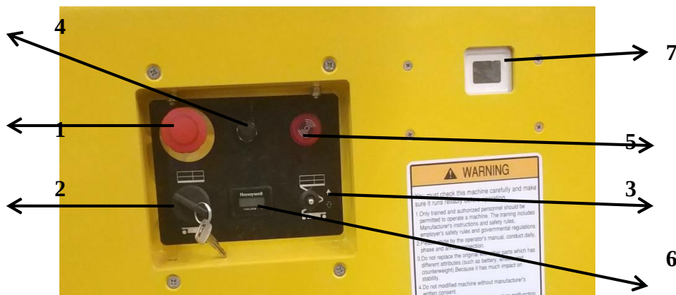
Рис. 3-2 Наземная панель управления
