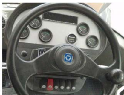
Рис. 3-2. Указатель уровня топлива в баке (опционально) на приборной панели
