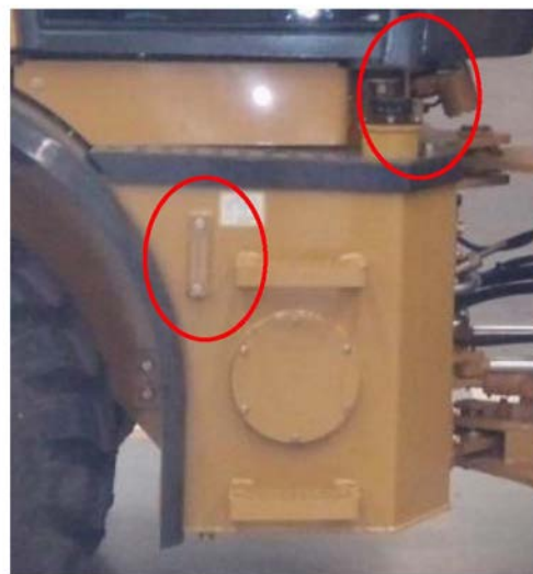
Рис. 3-6. Заправочное отверстие и указатель уровня масла бака гидравлического масла
