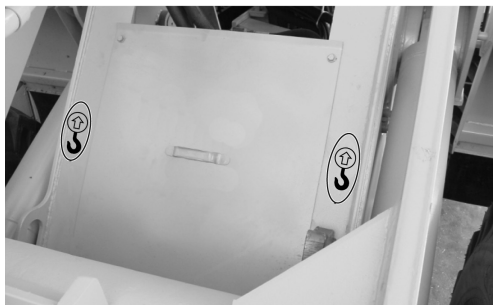
Рисунок 1.5 — Расположение знаков «Место строповки» на передней полураме
