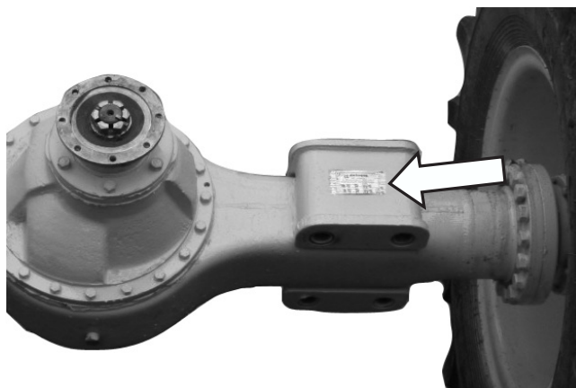
Рисунок 1.9 — Расположение маркировочной таблички ведущего моста
