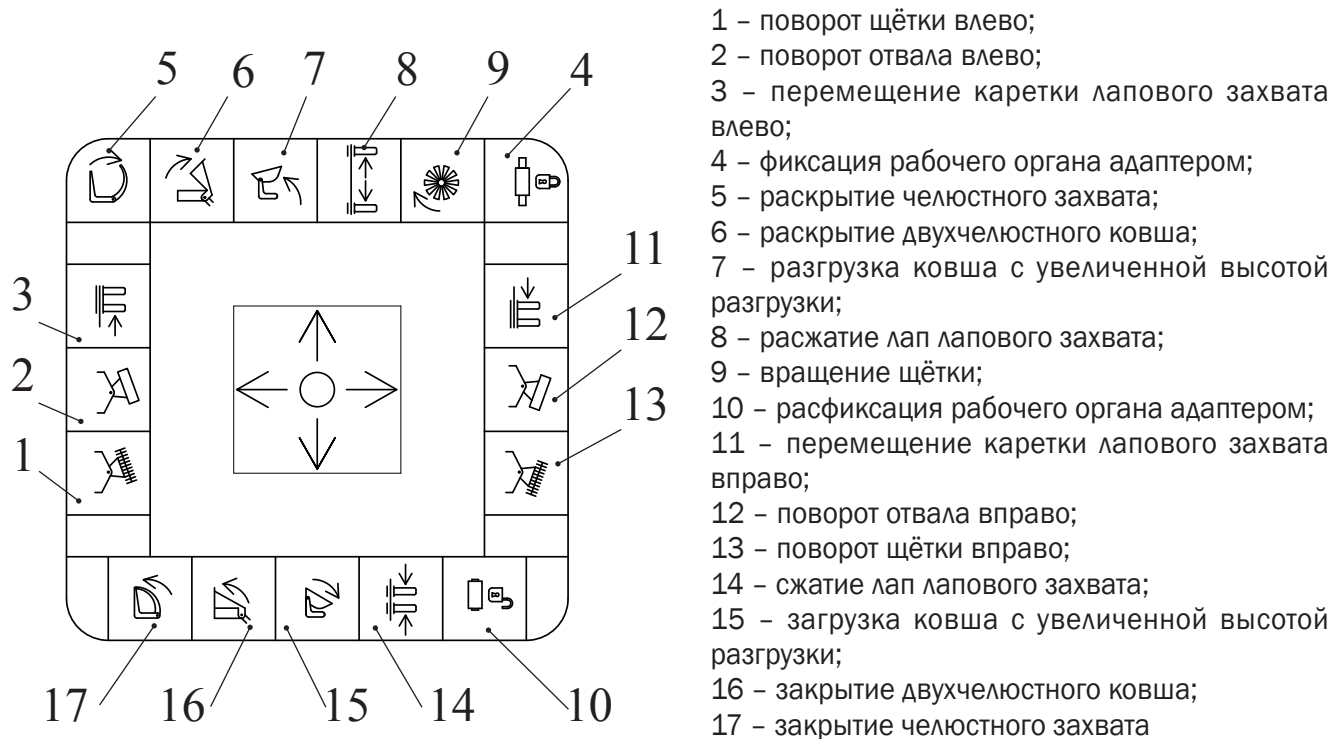
Рисунок 2.9 — Табличка управления рабочими органами погрузчика универсального
