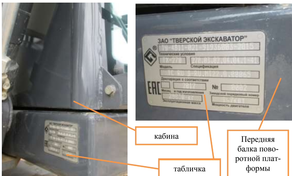
Рисунок .1.1.12 – Расположение маркировочной таблички
