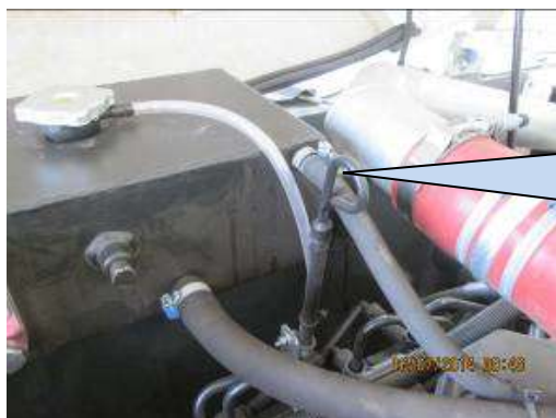
Рисунок 2.2.2 – Проверка уровня масла в двигателе
