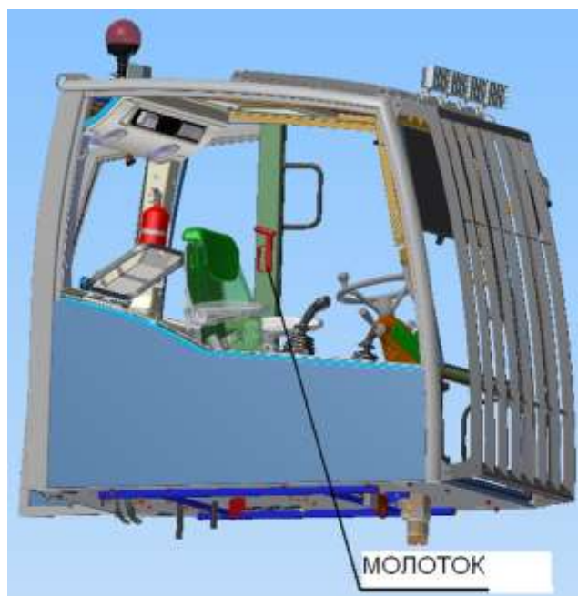
Рисунок 2.4.1 - Расположение молотка в кабине экскаватора
