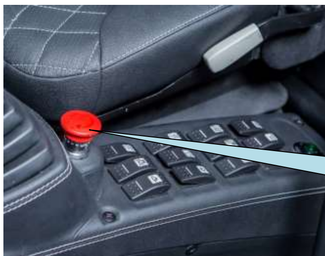
Рисунок 1.1.7 Аварийная кнопка останова двигателя и выключения гидропривода
