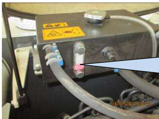
Рисунок 2.2.4 - Проверка уровня охлаждающей жидкости двигателя
