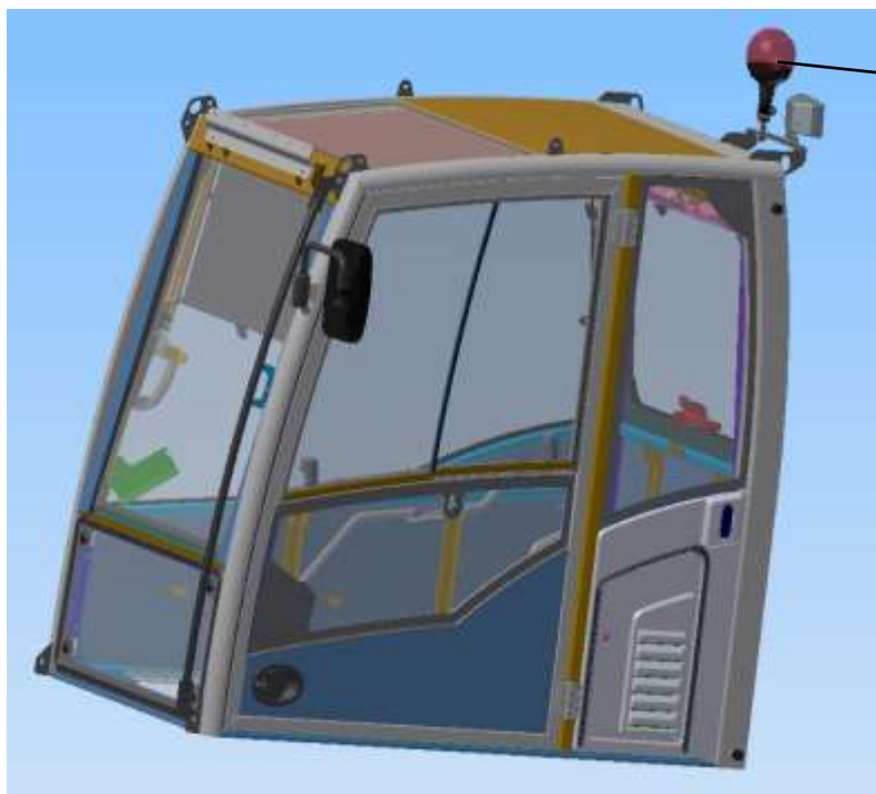
Рисунок 1.1.4 – Установка проблескового маяка
