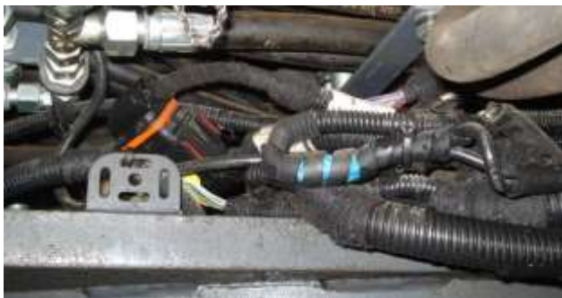
Рисунок 1.2.52 Соединительные колодки под полом кабины.
