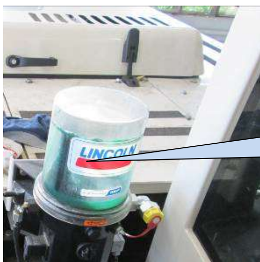
Рисунок 2.2.5 - Проверка уровня смазки в АЦСС
