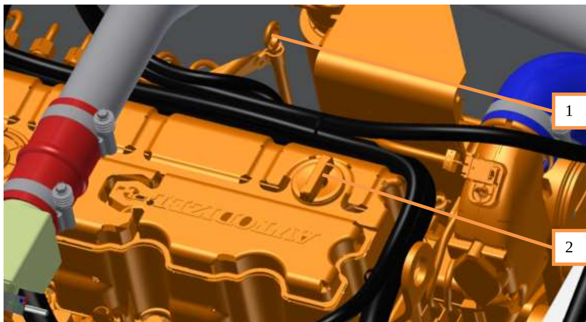
Рисунок 3.2.7 - Расположение масляного щупа и маслозаливной горловины 1 – щуп масляный; 2 – крышка маслозаливной горловины.
